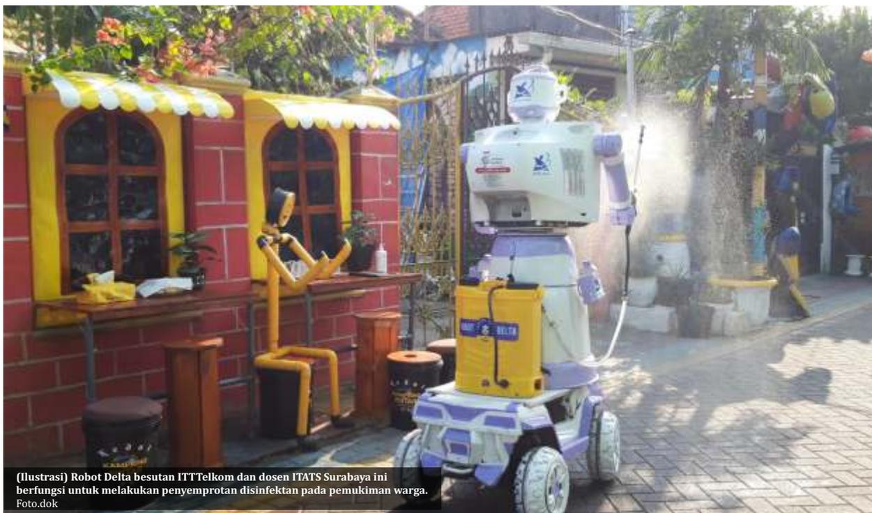
(Ilustrasi) Robot Delta besutan ITTTelkom dan dosen ITATS Surabaya ini berfungsi untuk melakukan penyemprotan disinfektan pada pemukiman warga. Foto.dok
