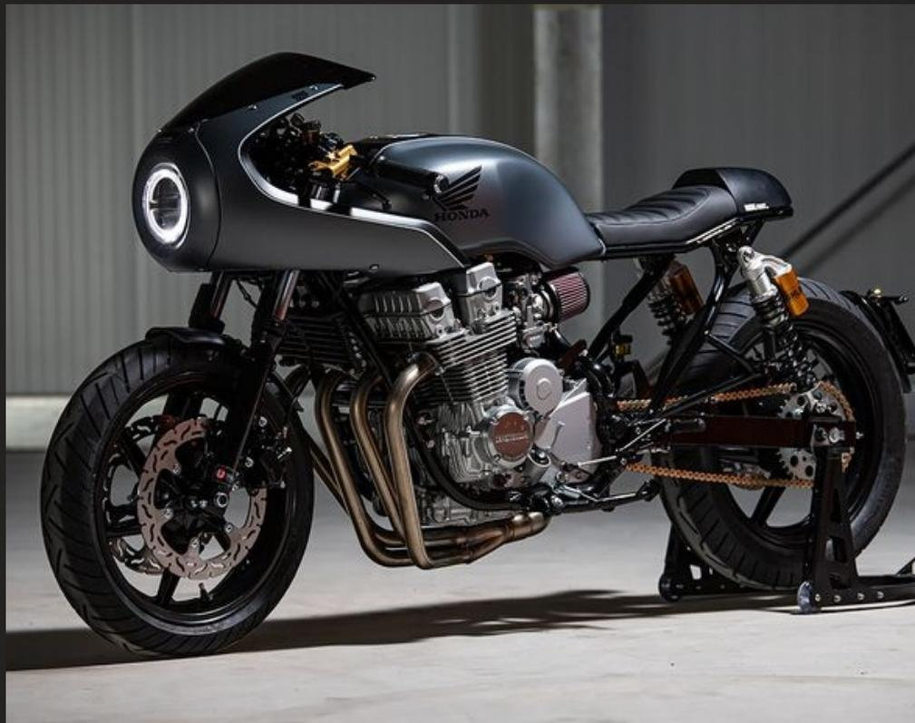
memodifikasi gaya ala Inggris dengan mengganti tangki bahan bakar berbahan aluminium dengan fiberglass. Mesin motor cafe racer juga mengalami konversi, yang awalnya tiga-silinder dua-stroke kemudian diubah jadi empat-silinder empat-stroke.
