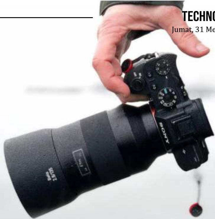
**KAMERA** mirrorless adalah jenis kamera digital yang menggunakan electronic viewfinder (EVF) atau layar LCD untuk mengkomposisikan foto, bukan penta prisma atau cermin reflektif seperti pada DSLR.
